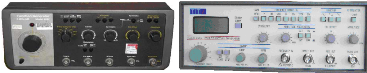
Σχ. 4.8. Γεννήτριες κυματομορφών.
